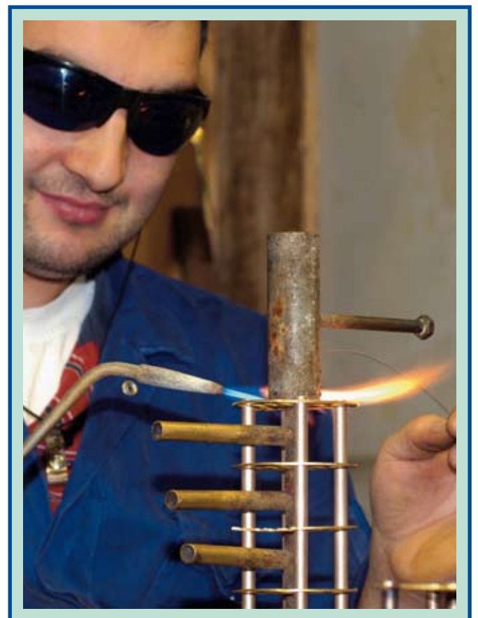
Löten der Kühlerelemente
