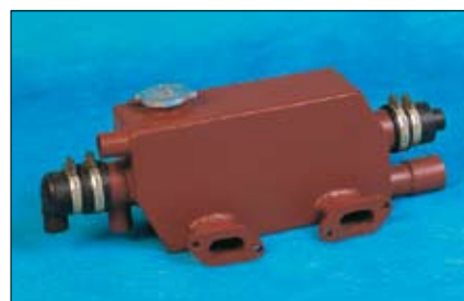
Mercedes OM636 (180D) + Ausgleichsbehälter + Wärmetauscher
